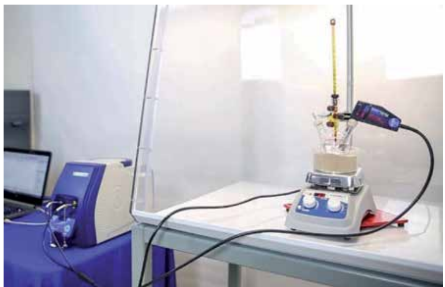
FIGURA 2. Espectrómetro portátil i-Raman® Plus con sonda de inmersión acoplada a fibra inmersa en el medio de reacción
