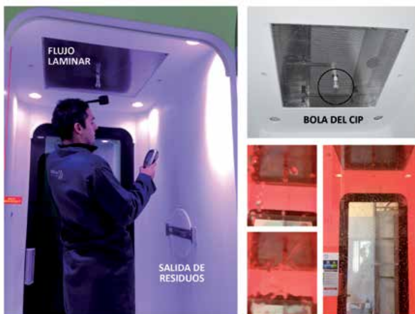
FOTO 6. CIP para limpieza interior tras fin de ciclo.
