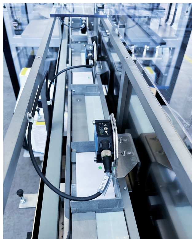
FIGURA 6. Los sistemas integrados de cámaras y sensores garantizan un control fiable del proceso y una alta calidad de envasado
