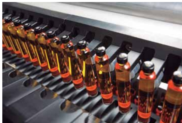
Los objetos son transportados a lo largo de la máquina cuidadosamente, sin llegar nunca a rozar los objetos vecinos. La sujeción se realiza, por ejemplo, por medio de vacío
