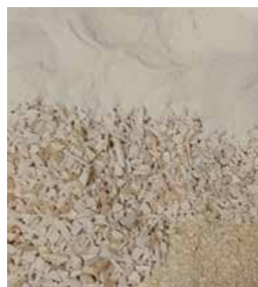
FIGURA 2. Imagen del producto inicial (parte superior), placas a la salida de los rodillos (parte inferior izquierda) y granulado por tamiz de 2.5 mm (parte inferior derecha)
