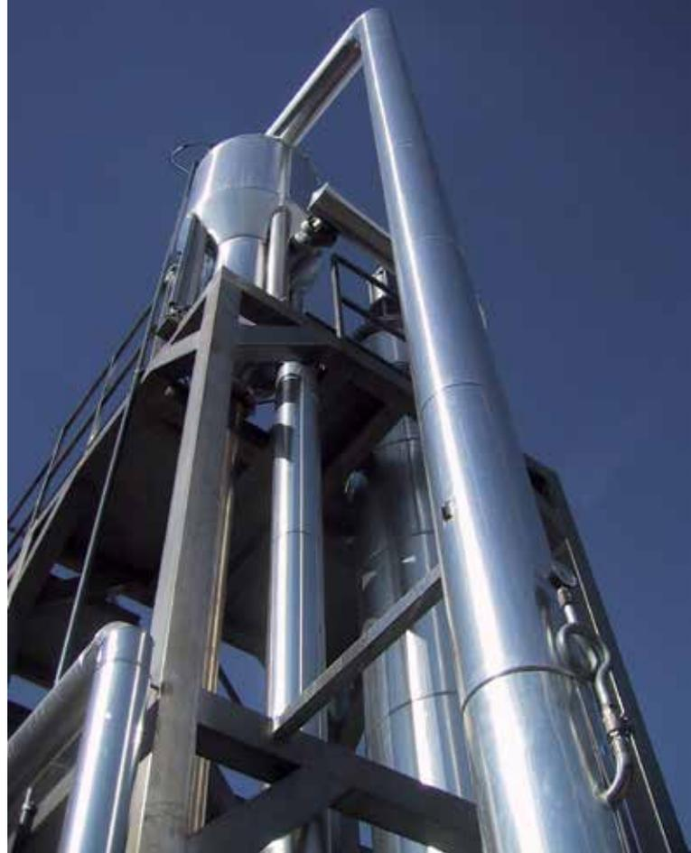
producto se evapora viaja descendiendo con la película líquida y la velocidad del vapor ayuda a mover la película a lo largo de la superficie de la pared del tubo.
